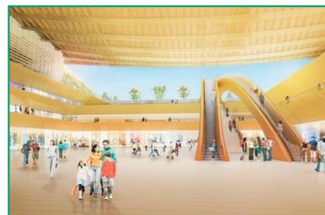
③► Le toit, composé d'une série d'ailettes de verre permettant l'évacuation des fumées en cas d'incendie, sera suspendu au-dessus du cratère sur une portée de 96 mètres. Nous voudrions au plus vite des réponses aux questions :
